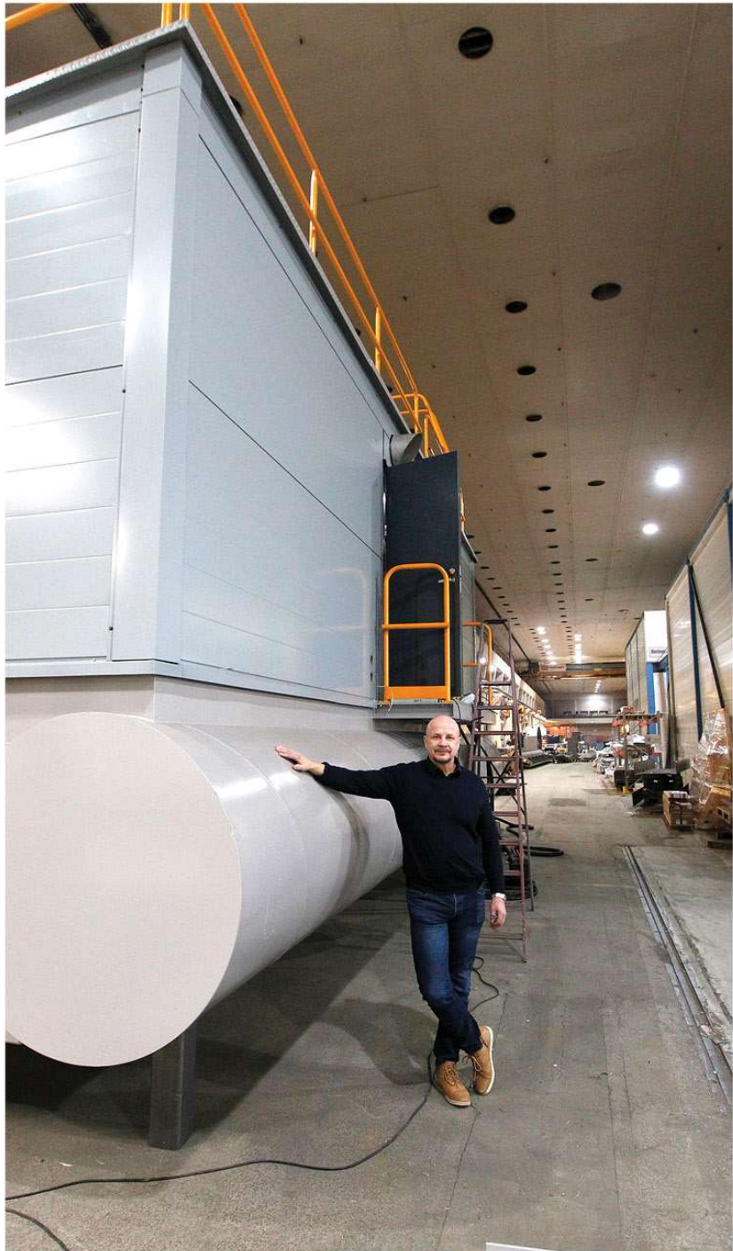
Katera Steel Oy:n uusi innovaatio on kaivosteollisuuden käyttöön valmistettu lauttapumppaamo. Yhtiön toimitusjohtaja on Taisto Suutari.
